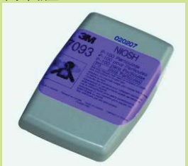
型號：3M-7093 品名：P100 防塵濾罐 符合美國 NIOSH 標 準。對粉塵過濾效率達 99.97%以上
